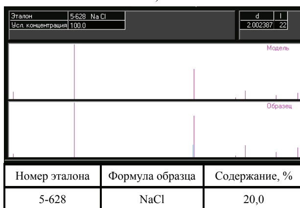
Рис. 5. Условный состав образцов хлората натрия, исследованного при 420 °С (а) и вновь взятого из упаковки (б), после нагревания и выдержки при температуре 500 °С в течение 1,5 ч
