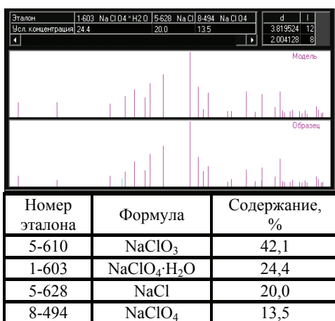
Рис. 4. Условный состав образцов хлората натрия производств А (а) и Б (б) после нагревания и выдержки при температуре 420 °С в течение 3,5 ч
