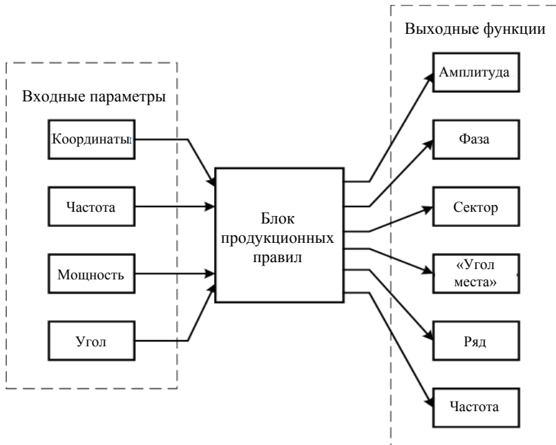
Рис. 12. Структурная схема системы нечеткой логики
