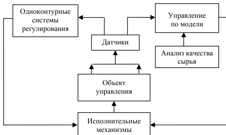
Рис. 2. Структурная схема управления диффузионным аппаратом по модели
