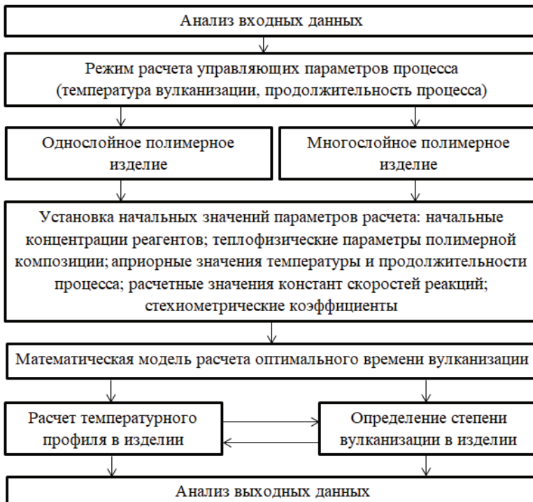
Рис. 2. Схема подсистемы моделирования кинетики вулканизации (а) и расчета оптимальных управляющих параметров (б)
