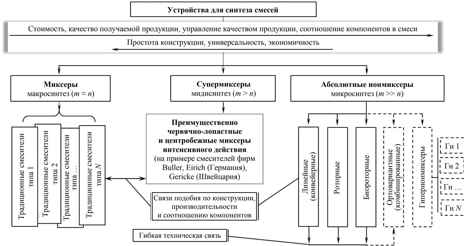
Рис. 2. Классификация устройств для синтеза смесей: n – ключевой компонент; m – наполнитель (пустые области – технические решения не разработаны или не защищены)
