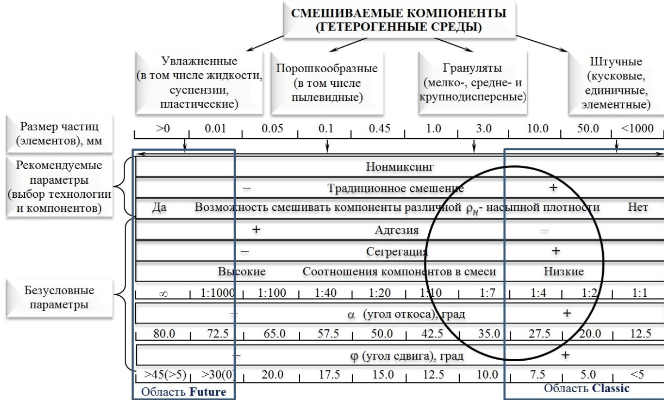
Рис. 1. Предлагаемая функциональная параметрическая классификация компонентов для выбора смесительного оборудования (нонмиксеров) и получения показателей качества смеси на уровне не ниже V_c \leq 1 - 10\% : ○ – оптимальная область выбора параметров смеси для проектирования смесителя (нонмиксера)
