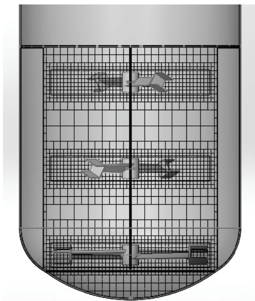
Рис. 2. Расчетная сетка КЭ для реактора получения сульфаминовой кислоты
