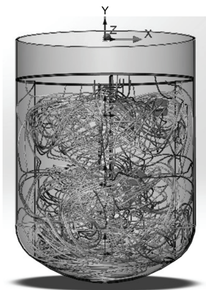
Рис. 4. Изображение потоков перемешиваемой среды в реакторе получения сульфаминовой кислоты
