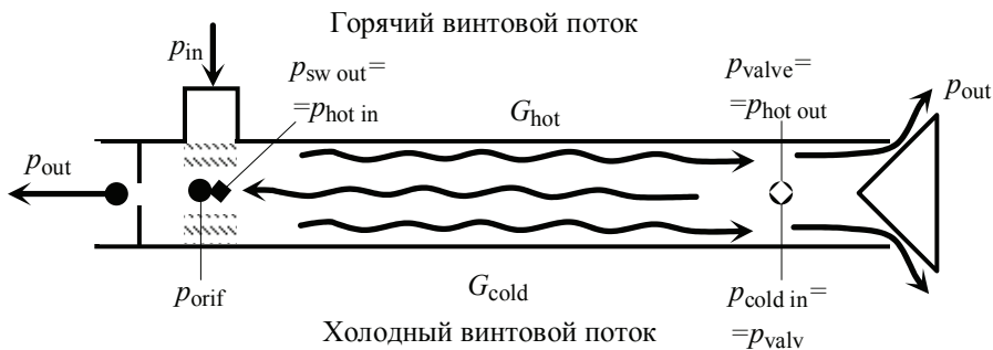
Рис. 4. Схема обозначений потоков и давлений по длине и сечению вихревой трубы
