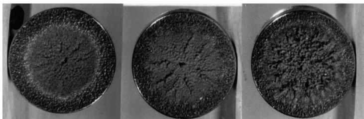
Рис. 1 Кинетика развития зоны кавитационной эрозии образцов стали 06Х12Н3Д после 3-х (а), 5-ти (б) и 15-ти (в) часов испытаний
