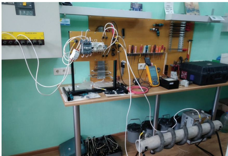
Рис. 7. Испытательная установка для тестирования УЗДП на эффективность срабатывания при параллельном дуговом пробое
