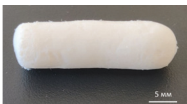
Рис. 5. Внешний вид гибридного аэрогеля на основе полиэлектролитного комплекса, соотношение альгинат натрия : хитозан – 1 : 1
