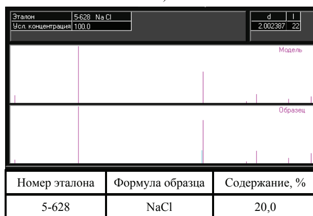
Рис. 5. Условный состав образцов хлората натрия, исследованного при 420 °С (a) и вновь взятого из упаковки (б), после нагревания и выдержки при температуре 500 °С в течение 1,5 ч
