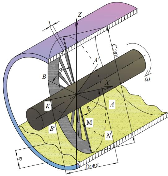
**Рис. 1. Схема взаимодействия лопастного смешивающего устройства с материалом**
