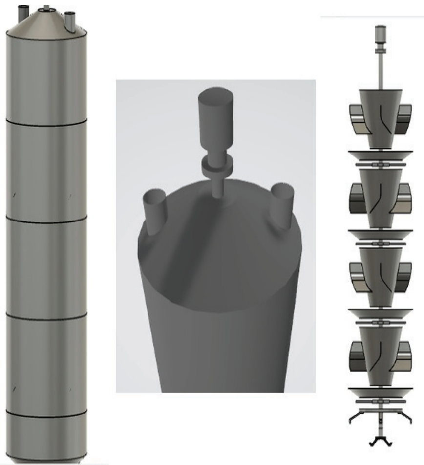
Рис. 1. 3D-модель каскадного гравитационного смесителя сыпучего материала
