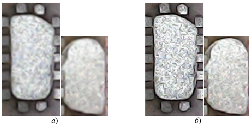
Рис. 5. Фрагмент изображения с дефектом типа «нависание» до (а) и после (б) управления положением камеры
