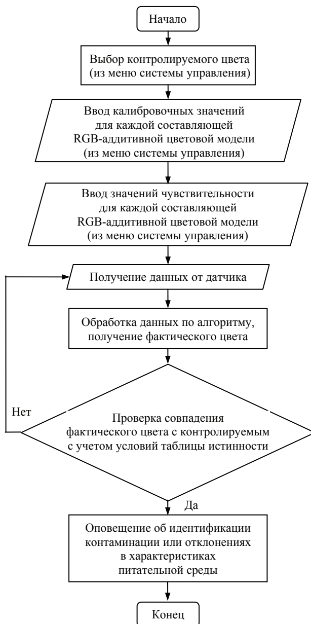
Рис. 4. Алгоритм автоматизированного контроля контаминации в питательной среде / растительном объекте, характеристик питательной среды (отклонений от регламентированных показателей)
