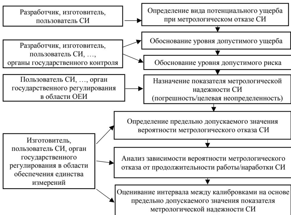
**Рис. 2. Порядок действий и исполнители при анализе риска метрологического отказа**
