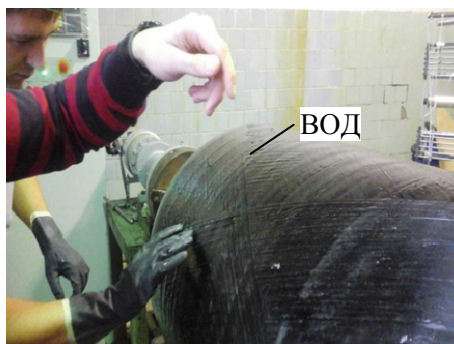
Рис. 6. Процесс закладки ВОД на основе ВБР в многослойное изделие в процессе его изготовления
