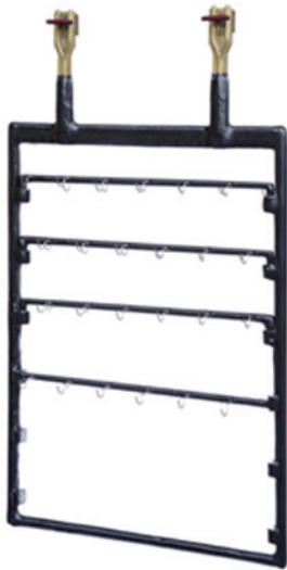
Рис. 1. Подвесочное устройство для обработки деталей в электрохимической ванне
