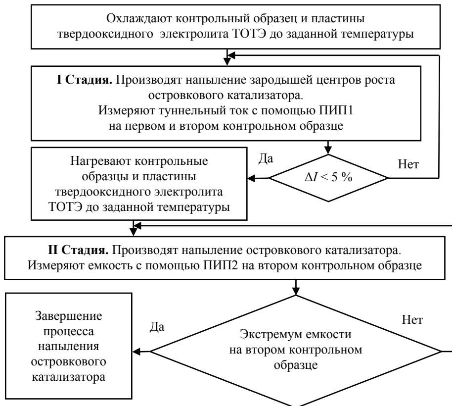
Рис. 4. Блок-схема алгоритма работы измерительно-управляющей системы для синтеза высокоэффективного катализатора в твердооксидных топливных элементах
