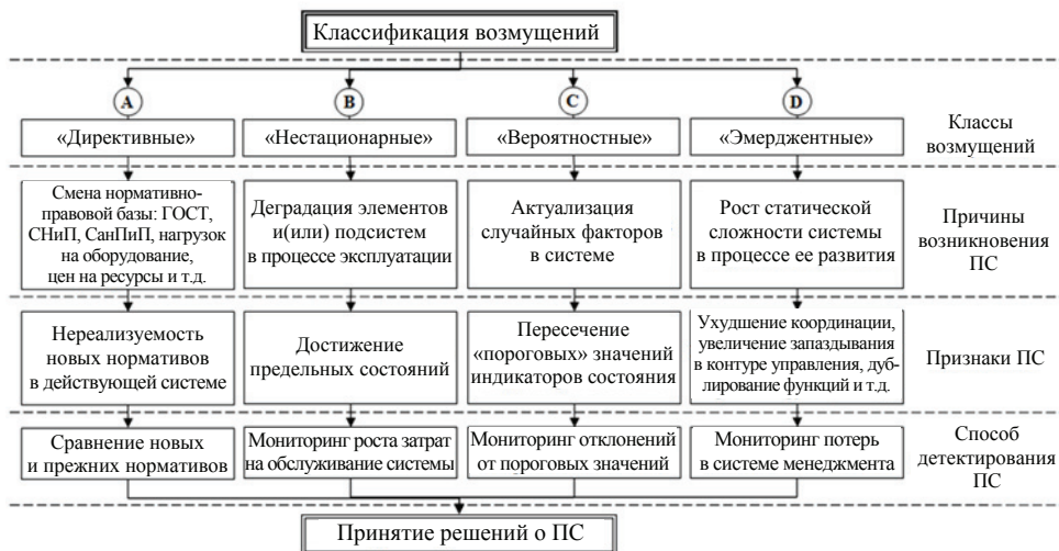
Рис. 3. Схема причин появления проблемных ситуаций (ПС – предельное состояние)
