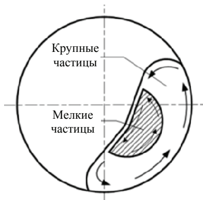
Рис. 3. Схема распределения мелких и крупных частиц в поперечном сечении гладкого вращающегося барабана
