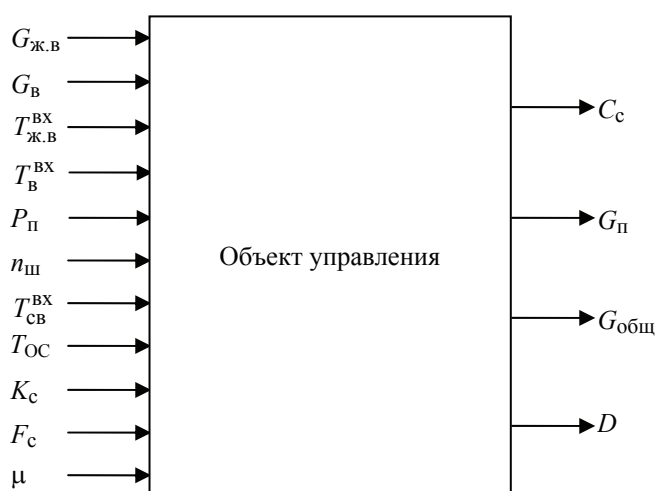
Рис. 2. Входные и выходные параметры объекта управления
