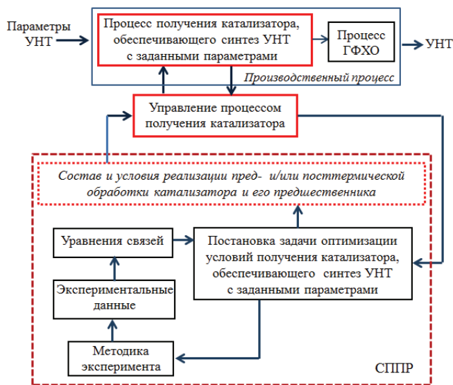
Рис. 2. Структура методологии создания системы информационной поддержки управления ТС производства УНТ
