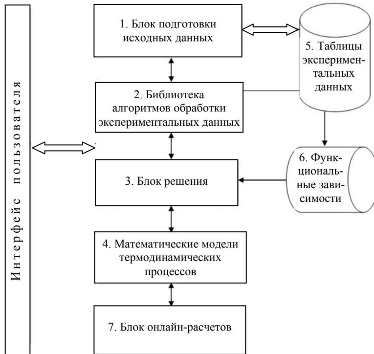
Рис. 1. Структурная схема программного комплекса
