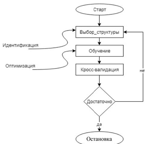
**Рис. 5. Блок-схема одного из вариантов процесса обучения модели**
