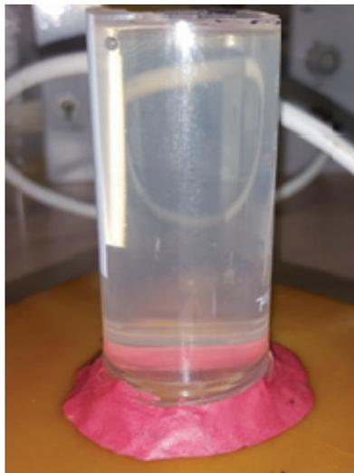
**Рис. 2.** Фантом из PAA/BSA геля, размещенного на сферической фокусирующей акустической линзе
