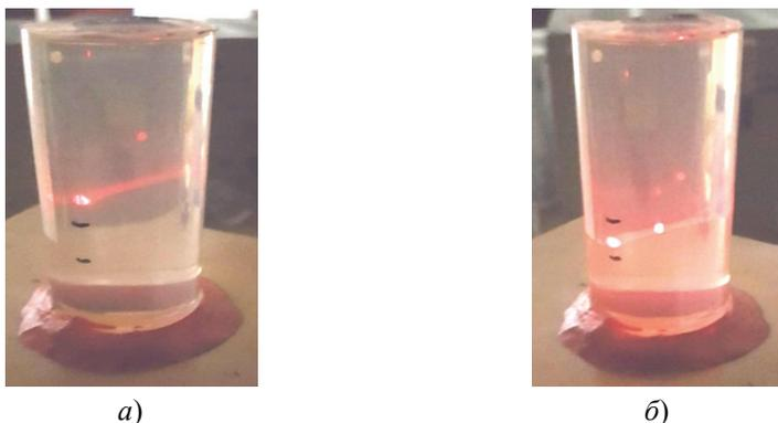
Рис. 6. Фотографии фантома из PDMS после воздействия сфокусированного УЗ-пучка:
