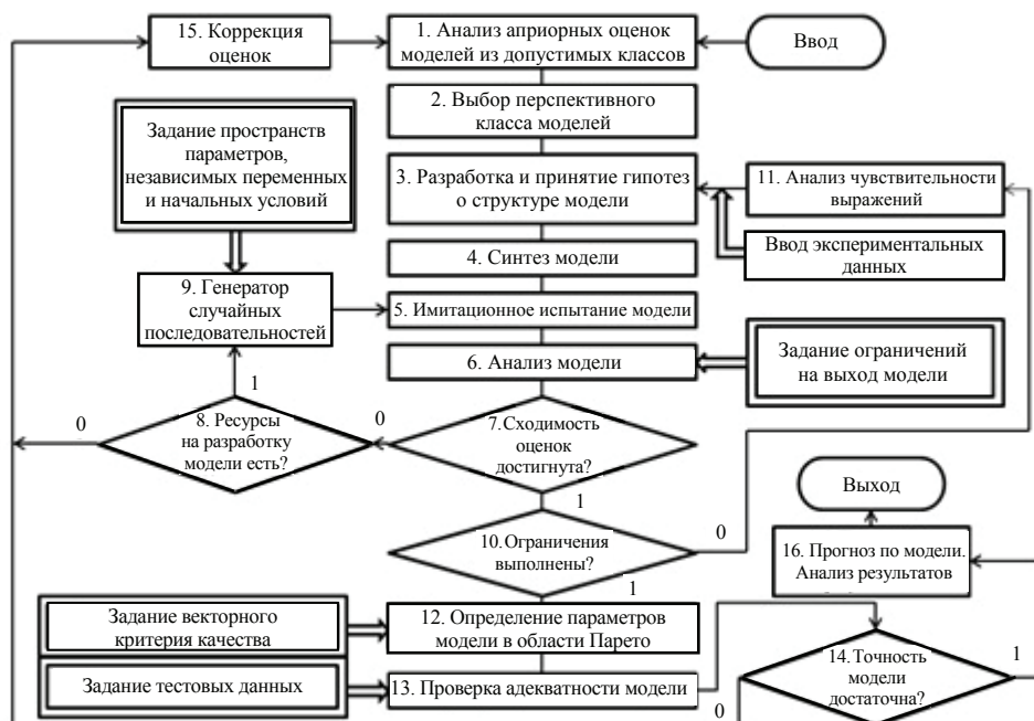
Рис. 7. Основные этапы автоматизированного моделирования
