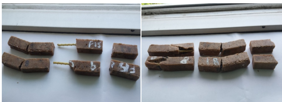
Рис. 4. Образцы после разрушения: a – при F0 – F25; б – при F50, F100
