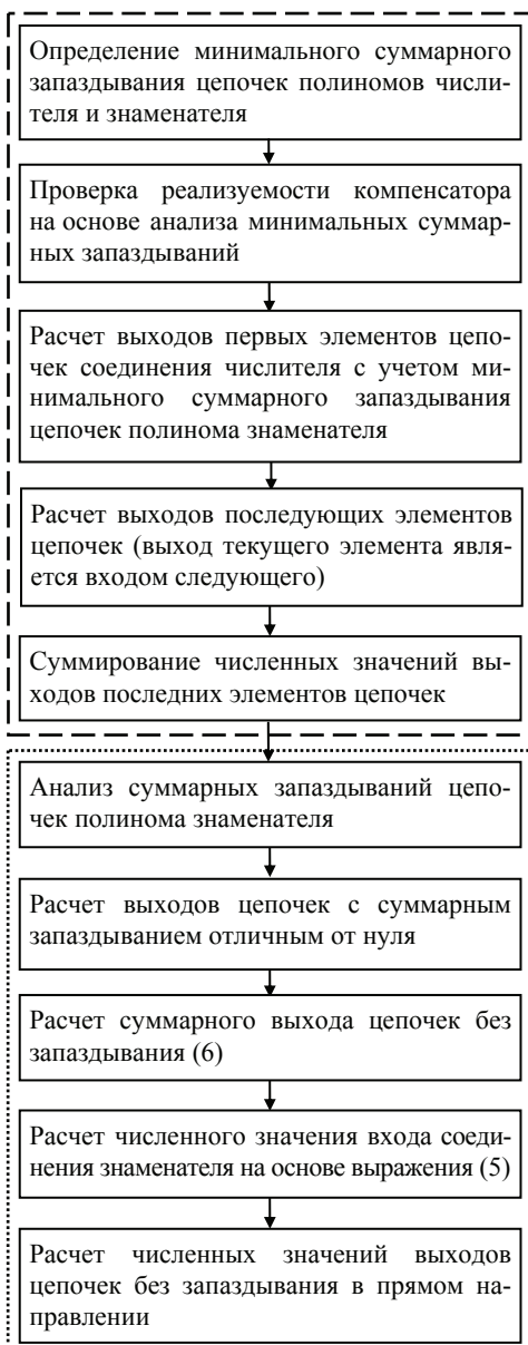
Рис. 6. Схема алгоритма расчета численного значения выхода звена с ПФ (2)
