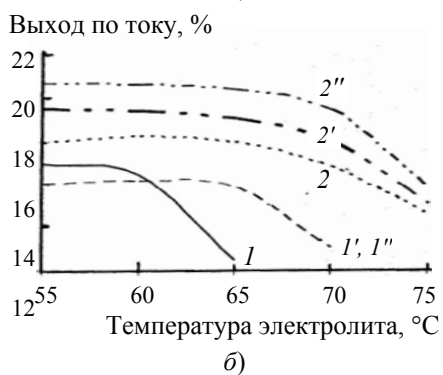
Рис. 6. Изменение выхода по току в зависимости от плотности реверсивного тока при 55 °С (а) и температуры при плотности реверсивного тока 100 А/дм 2 (б) в тех же электролитах
