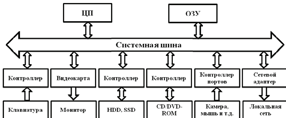
Рис. 4. Структурная схема персонального компьютера
