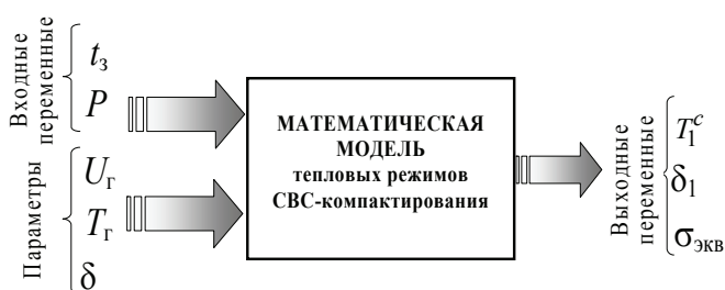
Рис. 5. Структурная схема модели тепловых режимов процесса СВС-компактирования
