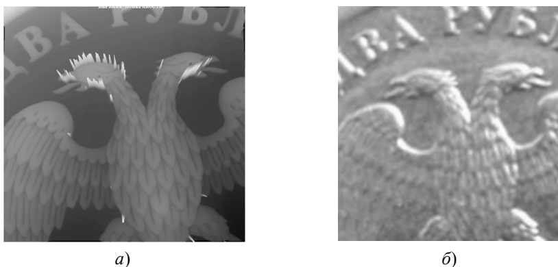
Рис. 4. Изображение поверхности монеты: а – акустическое; б – фотография
