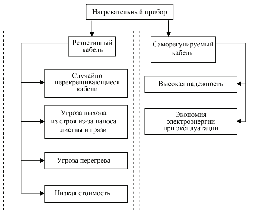
Рис. 2. Применение нагревательного кабеля постоянного тока
