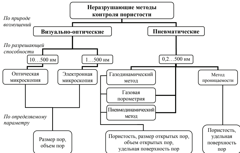
Рис. 2. Классификация неразрушающих методов контроля пористости материалов
