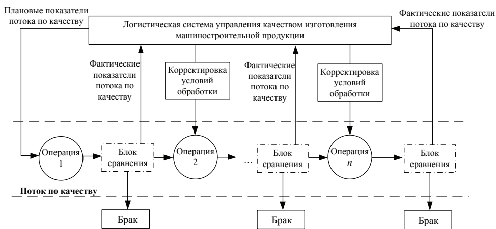
Рис. 3. Реализация управления потоком по качеству на всей совокупности технологического процесса
