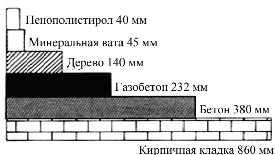
Рис. 1. Соотношение толщин различных материалов при одинаковом термическом сопротивлении
