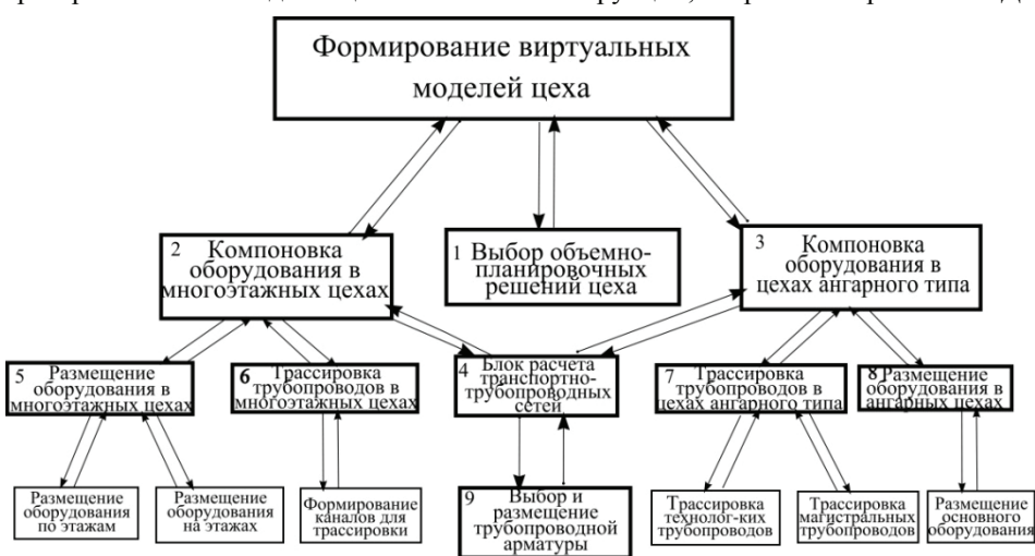
Рис. 1. Схема формирования виртуальной модели цеха
