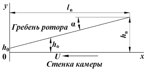
Рис. 1. Геометрическая схема деформации эффективного объема материала
