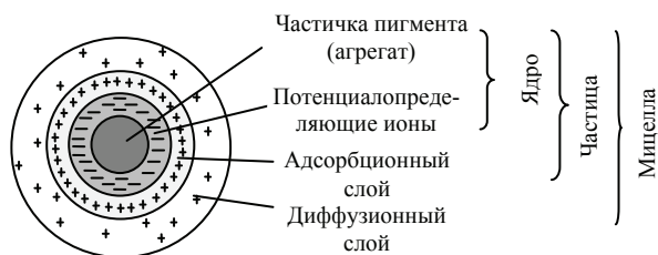
Рис. 1. Схема образования двойного электрического слоя вокруг частицы пигмента, находящейся в растворе
