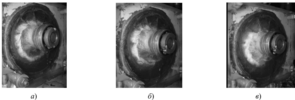
Рис. 7. Фотографии жидкостного кольца: а – q_{\text{ДПРЖ}} = 0,08 \text{ м}^3/\text{ч} ; б – q_{\text{ДПРЖ}} = 0,13 \text{ м}^3/\text{ч} ; в – q_{\text{ДПРЖ}} = 0,24 \text{ м}^3/\text{ч} ; P_{\text{вс}} = 0 кПа
