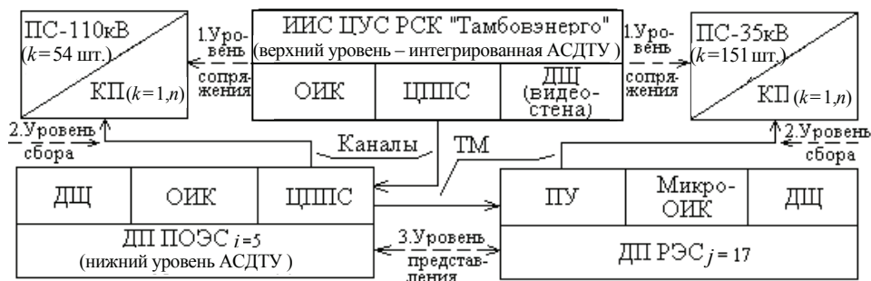
Рис. 1. Структура двухуровневой информационно-измерительной системы центра управления сетей региональной сетевой компании «Тамбовэнерго»
