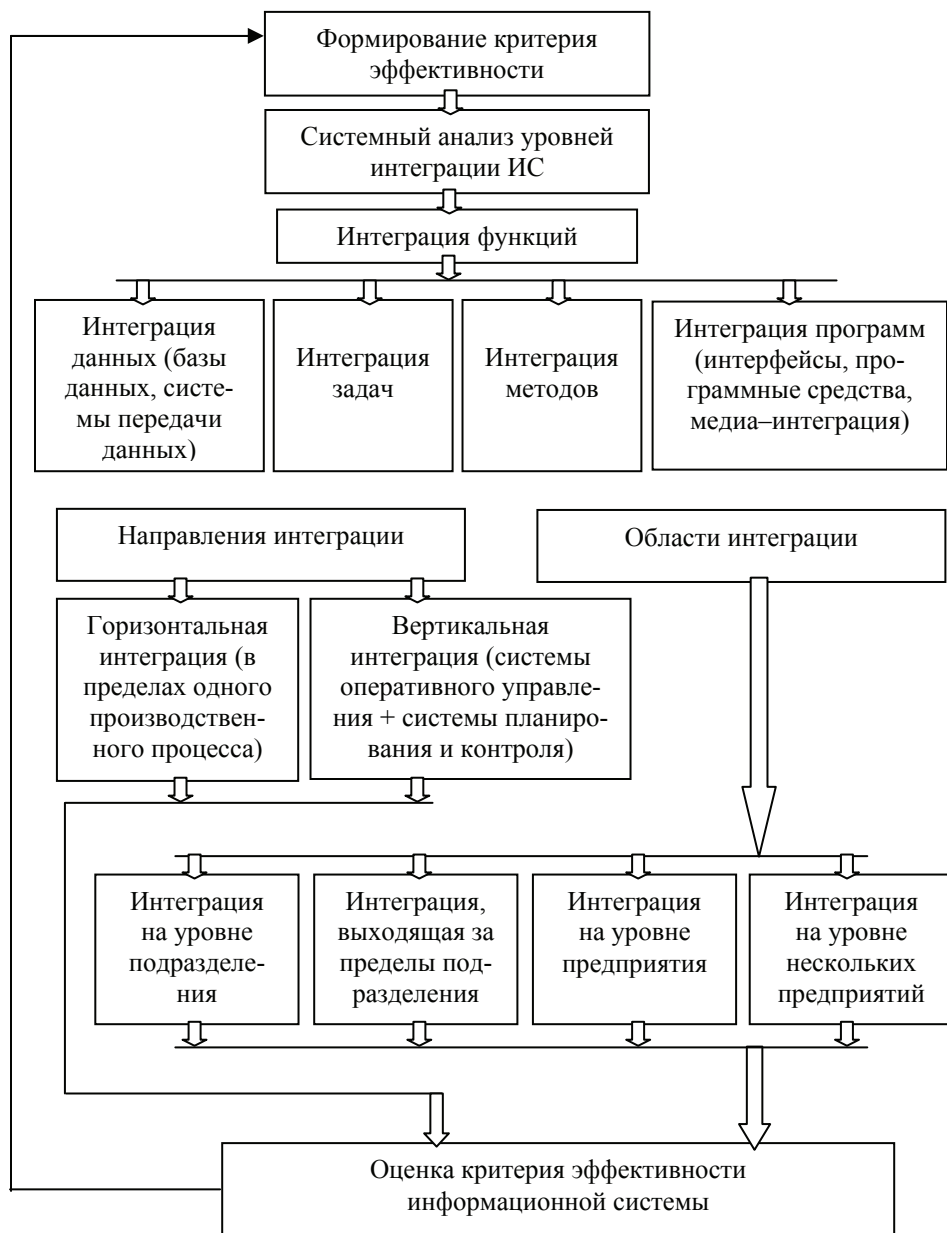
Рис. 3. Системный подход к оценке эффективности информационной системы на основе критерия, определяемого отношением объема выполненных работ по обработке информации к полной стоимости владения C_{\text{ТСО}}
