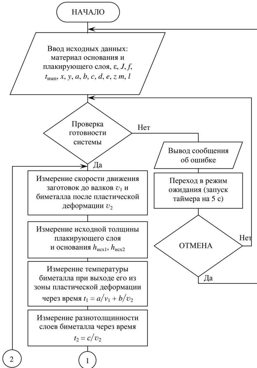
Рис. 2. Алгоритм работы измерительной системы контроля характеристик качества биметалла
