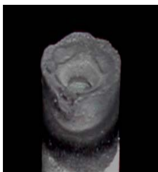
Рис. 4. Внешний вид эрозии графитового анода
