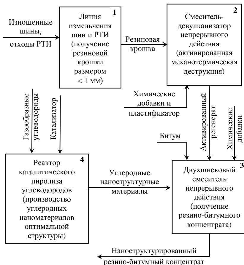
Рис. 1. Структурная схема технологического комплекса по переработке изношенных шин и отходов РТИ в наноструктурированный резино-битумный концентрат
