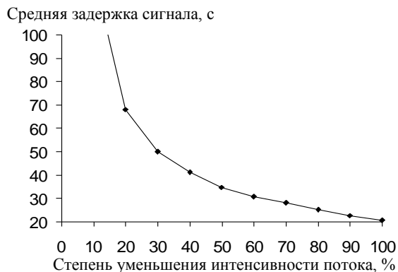
Рис. 6. Зависимость средней задержки сигналов от степени уменьшения интенсивности потока во время импульсов
