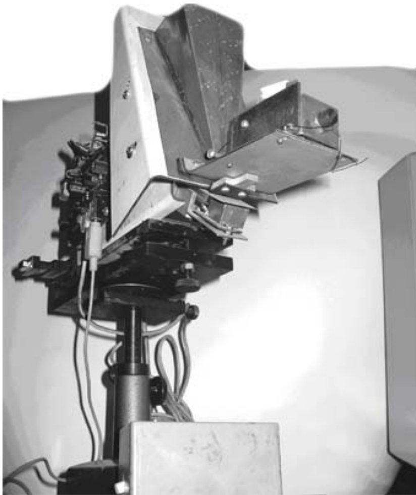
Рис. 2. Экспериментальная установка для непрерывного весового дозирования зернистых материалов
