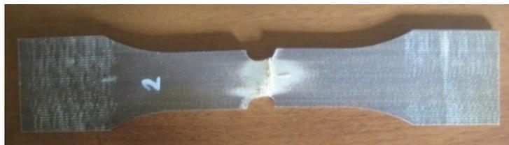
Рис. 6. Разрушенный образец с концентратором напряжения после испытания
