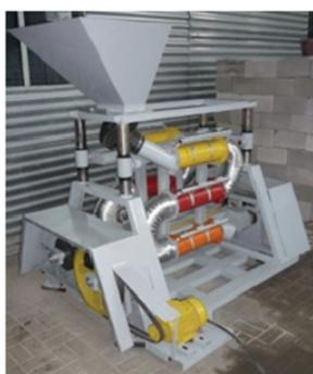
**Рис. 3. Центробежный помольно-смесительный агрегат**
