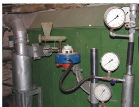
**Рис. 4. Конструкция вихреакустического диспергатора с одной камерой помола**
