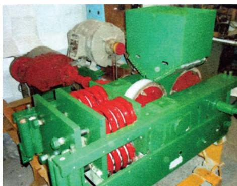
**Рис. 2. Пресс-валковый измельчитель с цилиндрическим профилем валков**
