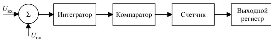
Рис. 2. Функциональная схема АЦП двухтактного интегрирования
